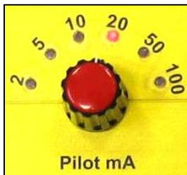
Mit diesem Schalter wird der Strombereich des Pilot-Servoventils eingestellt. Es handelt sich um den Strombereich von 0 bis 2mA, 0 bis 5 mA etc., der Strom selbst wird dann von dem Prüfstand ValveExpert gesteuert, und zwar in der Steuerung von  $\pm 10$  Volt. Achtung: der Strombereich geht direkt in der Verstärkung des Positionsregelkreises ein. Ein zu hoher Strombereich führt zu Instabilitäten.
