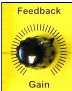
Mit diesem Potentiometer wird die Kreisverstärkung des Positions-Regelkreises eingestellt. Diese Einstellung hat feinfühlig zu erfolgen. Eine zu hohe Kreisverstärkung führt zu Instabilitäten. Eine zu kleine Kreisverstärkung hat Auswirkung auf die Qualität des Ausgangs-Signals des Positionsgebers (Hysterese, Nicht-Linearitäten...)
