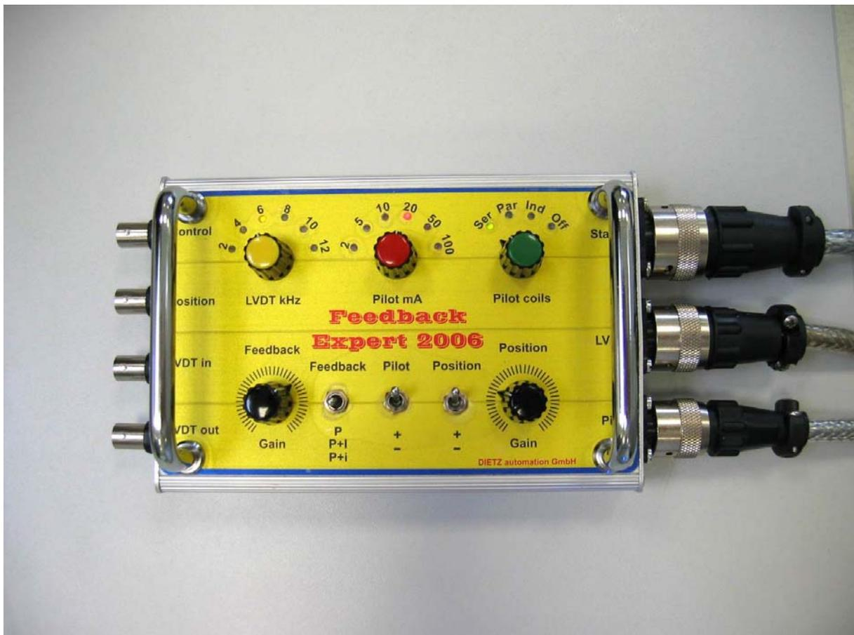
Diese Elektronik dient dazu Servoventile, welche mit einem Positionsgeber am Steuerkolben ausgerüstet sind, und die auch nicht über eine interne Elektronik verfügen, im Zusammenhang mit dem Prüfstand ValveExpert zu testen.
