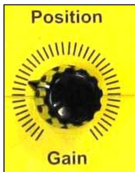
Mit diesem Potentiometer wird der Wert des Ausgangssignals des Potentiometers eingestellt. Bei maximalem Hub des Steuerkolbens der dritten Stufe stellt man diesen auf einen gewünschten Spannungswert ein, zum Beispiel 10 Volt.
