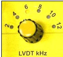
Mit diesem Schalter wird die Frequenz der Speisespannung der Primärspule des LVDT Weggebers eingestellt. Je nach Art und Hersteller sind diese Frequenzen unterschiedlich. Die Elektronik Feedback-Expert ermöglicht Einstellungen von 2 bis 12 kHz in Stufen von je 2 kHz. Die gewählte Frequenz wird durch eine Leuchtdiode angezeigt.
